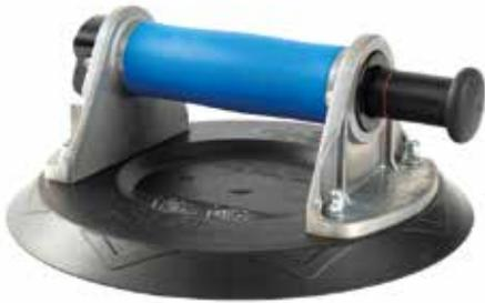
**i** Ventosa de pistón de aluminio robusto para cargas grandes. Mango con revestimiento antideslizante. El pistón redondo facilita una operación rápida y cómoda. Control permanente del vacío mediante el anillo rojo en el pistón. La ventosa es apropiada para todos los materiales con superficies planas y herméticas. Gracias a su plato de goma más suave, la ventosa de pistón tiene una mayor duración de agarre y es además apropiado también para superficies ligeramente rugosas.
