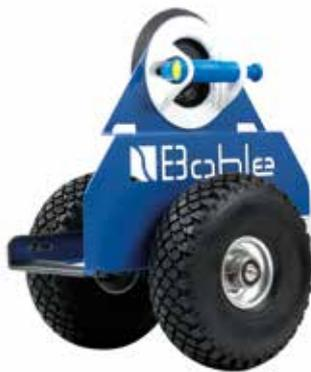
**i** Altura 575 mm · Ancho 410 mm · Capacidad de carga hasta 300 kg · Espesor mínimo del material a transportar 3 mm · Altura máxima del material a transportar 2000 mm · Longitud máxima del material a transportar 3000 mm
