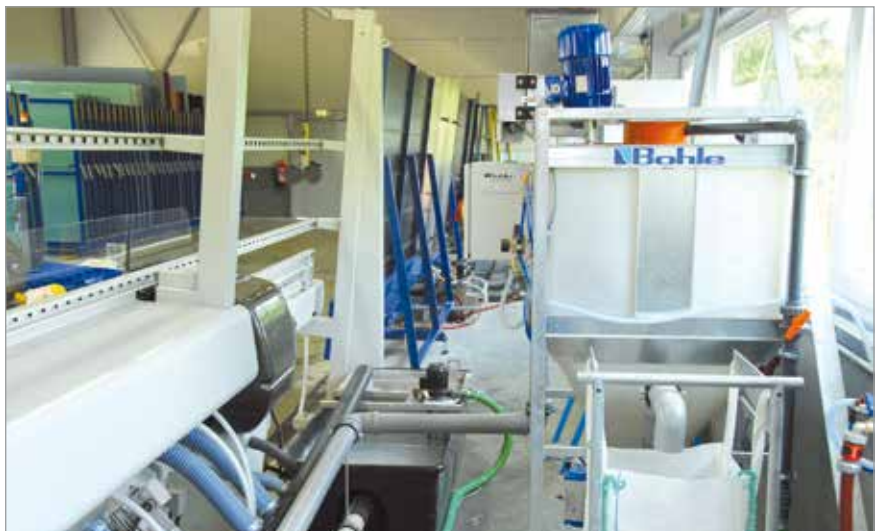
„Der Abtrag, die Kühlung sowie die Standzeiten der Schleifbänder werden durch sauberes Kühlwasser deutlich verbessert und die geringere Verschmutzung führt zu einfacherem Reinigen der kompletten Anlage“, berichten die Bediener der Maschinen von Egger Glas.
