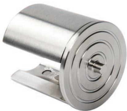
**i** Klebeadapter zur schraubenlosen Bodenbefestigung · mit Riffelung der Unterseite für optimale Klebstoffverteilung · lediglich eine Stabilisationsbohrung im Boden wird benötigt
