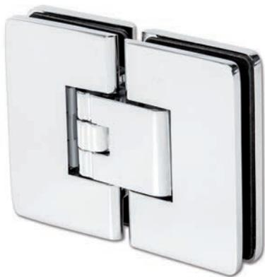
**i** Glasdicke 8 mm · selbstschließend ab 15° · stufenlose Einstellbarkeit der Nulllage · Lieferung ohne Befestigungsmaterial
