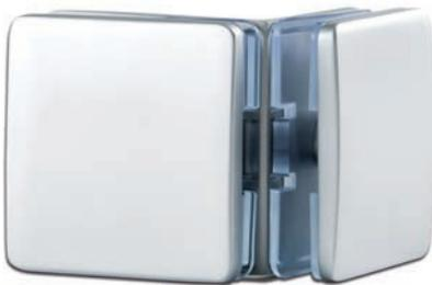
**i** Glasdicke 8, 10 mm · Lieferung ohne Befestigungsmaterial · Für stehende Trennwände · Maß  $x = 29 \text{ mm} + \text{Glasdicke}$
