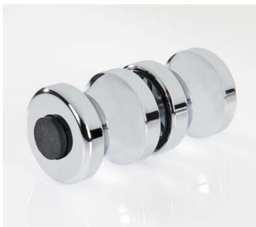
**i** Glasdicke ESG 6, 8, 10, 12 mm · Lochbohrung im Glas  $\varnothing 14$  mm · mit beidseitigem Puffer
