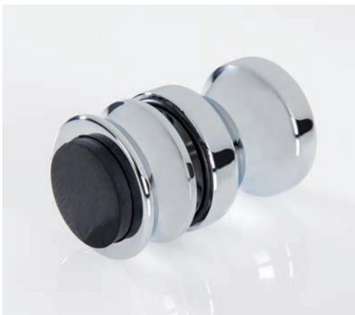
**i** Glasdicke ESG 6, 8, 10, 12 mm · Lochbohrung im Glas  $\varnothing 14$  mm · mit einseitigem Puffer
