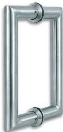
**i** Glasdicke ESG 6, 8, 10, 12 mm · Abstand Lochbohrungen Mitte (C-C) 152 mm · Lochbohrung im Glas  $\varnothing$ 10 mm
