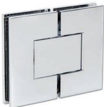
**i** Glasdicke 8, 10, 12 mm · selbstschließend ab 15° · stufenlose Einstellbarkeit der Nulllage · Lieferung ohne Befestigungsmaterial
