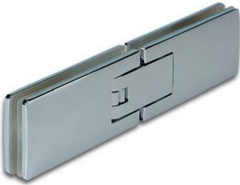
**i** Glasdicke 8, 10 mm · Einstellbarkeit der Nulllage  $\pm 5^\circ$  · Lieferung ohne Befestigungsmaterial · Zur Montage eines Türflügels an einem feststehenden Seitenteil
