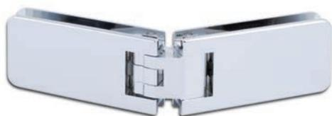
**i** Glasdicke 8, 10 mm · selbstschließend ab 15° · stufenlose Einstellbarkeit der Nulllage · Lieferung ohne Befestigungsmaterial · Zur Montage eines Türflügels an einem Seitenteil
