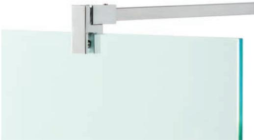
Stange individuell kürzbar · verstellbarer Wandanschluss · verdeckte Schrauben · Glasdicke 8, 10 mm
