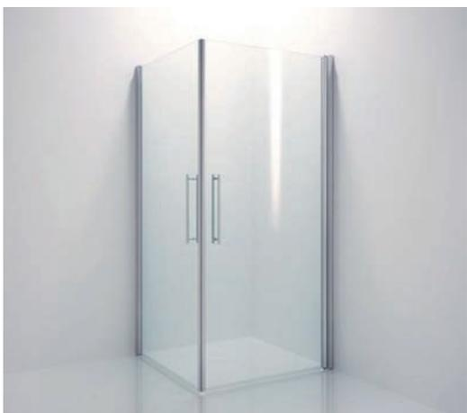
**i** Glasdicke 8 mm · Hubhöhe 5 mm · Feststellung beidseitig bei 90° · Profillänge 2200 mm · beliebig kürzbar · Für zweiflügelige Anwendungen bitte zwei Sets bestellen. · Für die Anbindung an Seitenteile sind Ergänzungsprofile als Zubehör erhältlich. · Das Abzugsmaß von 13 mm ist im Glasausschnitt berücksichtigt, um die Dichtung BO 5213494 einzusetzen. Bei Verwendung einer anderen Dichtung muss der Glasausschnitt angepasst werden.
