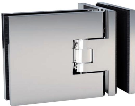
**i** Glasdicke 8, 10 mm · max. Türbreite (bei 10 mm Glas) beträgt 850 mm · selbstschließend · stufenlose Einstellbarkeit der Nulllage
