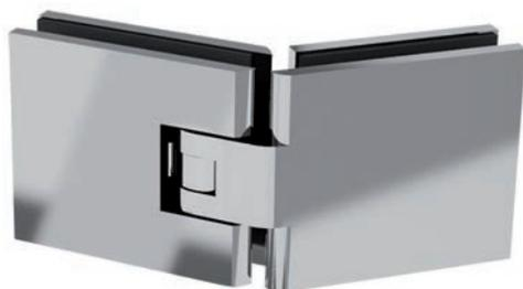
**i** Glasdicke 8, 10 mm · max. Türbreite (bei 10 mm Glas) beträgt 850 mm · selbstschließend · stufenlose Einstellbarkeit der Nulllage
