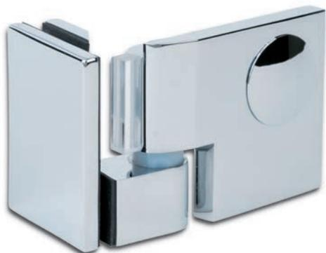
**i** Glasdicke 8 mm · Hubhöhe 5 mm · Das Abzugsmaß von 13 mm ist im Glasausschnitt berücksichtigt, um die Dichtung BO 5213494 einzusetzen. Bei Verwendung einer anderen Dichtung muss der Glasausschnitt angepasst werden.
