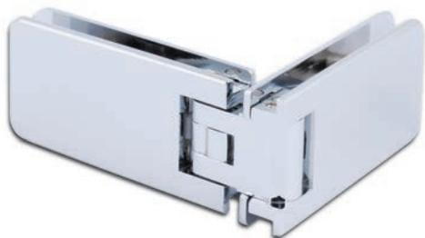
**i** Glasdicke 8, 10 mm · selbstschließend ab 15° · stufenlose Einstellbarkeit der Nulllage · Lieferung ohne Befestigungsmaterial · Zur Montage eines Türflügels an einem Seitenteil
