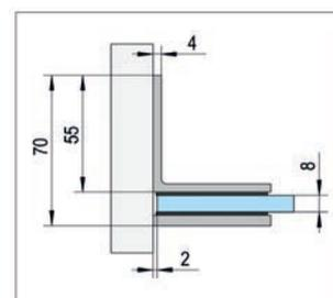
**i** Espesor 8, 10, 12 mm · Se entrega sin material de fijación. · Para tabiques fijos
