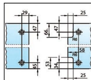
**i** Espesor 8 mm · Altura de elevación 5 mm · La medida de deducción de 13 mm ya está incluida en la muesca para insertar el deflector de agua BO 5213494. Si se utiliza otro deflector, hay que adaptar la muesca respectivamente.
