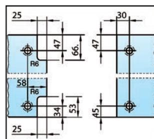
**i** Espesor 8 mm · La medida de deducción de 13 mm ya está incluida en la muesca para insertar el deflector de agua BO 5213494. Si se utiliza otro deflector, hay que adaptar la muesca respectivamente.
