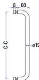
❗ Espesor vidrio templado 6, 8, 10, 12 mm · Distancia a los orificios centrales (C-C) 610 mm · Taladro en vidrio ø 12 mm
