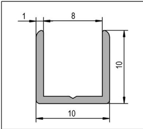
❶ Aplicaciones: ensamblaje de tabiques de vidrio permanentes, protección de bordes, marcos decorativos y varias aplicaciones · Esquinas redondeadas · Guía de broca en la parte inferior del perfil · Resistente a la corrosión y, por lo tanto, adecuada para su uso en el baño y la cocina.
