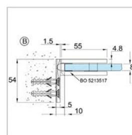
❗ Espesor 8, 10, 12 mm · Autocierre a partir de 15° · Posición zero de ajuste continuo · Se entrega sin material de fijación.
