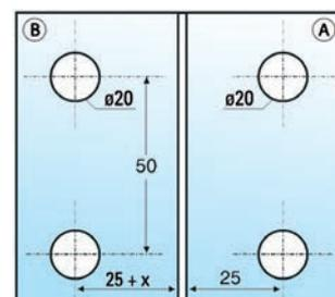
**i** Espesor 8, 10, 12 mm · Se entrega sin material de fijación. · Para tabiques fijos · x = espesor vidrio
