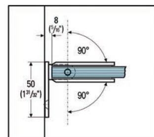
**i** Espesor 8, 10, 12 mm · Autocierre a partir de 15° · Se entrega sin material de fijación.
