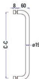
❗ Espesor vidrio templado 6, 8, 10, 12 mm · Distancia a los orificios centrales (C-C) 457 mm · Taladro en vidrio ø 12 mm
