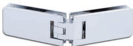
❶ Espesor 8, 10 mm · Autocierre a partir de 15° · Posición zero de ajuste continuo · Se entrega sin material de fijación. · Para el montaje de una puerta batiente en un panel lateral
