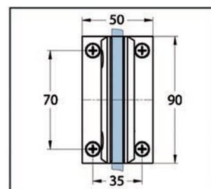
**i** Espesor 6, 8, 10 mm · Se entrega sin material de fijación.
