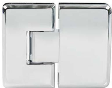
**i** Espesor 8, 10, 12 mm · Autocierre a partir de 15° · Posición zero de ajuste continuo · Se entrega sin material de fijación. · Para el montaje de una puerta batiente en un panel lateral
