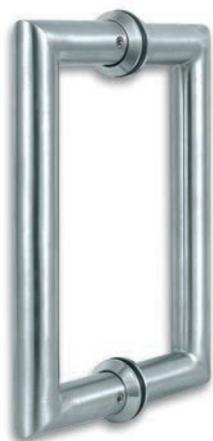
**i** Espesor vidrio templado 6, 8, 10, 12 mm · Distancia a los orificios centrales (C-C) 152 mm · Taladro en vidrio  $\varnothing$  10 mm
