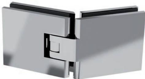
❶ Espesor 8, 10 mm · La máx. anchura de la puerta (para vidrio de 10 mm) se eleva a 850 mm. · Sistema de cierre automático · Posición zero de ajuste continuo
