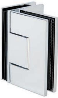
**i** Espesor 8, 10, 12 mm · Autocierre a partir de 15° · Posición zero de ajuste continuo · Se entrega sin material de fijación.
