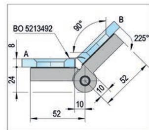
**i** Espesor 6, 8 mm · Altura de elevación 5 mm · Las puertas se mantienen cerradas mediante juntas magnéticas.
