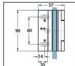
**i** Espesor 6, 8 mm · Agujero oblongo para montaje a pared · Sin necesidad de muescas en el vidrio · Solo se requieren taladros
