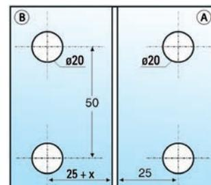
**i** Espesor 8, 10, 12 mm · Se entrega sin material de fijación. · Para tabiques fijos · x = espesor vidrio
