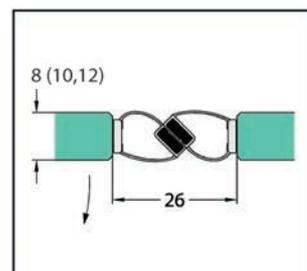
con deflector de agua y amortiguador en la parte inferior para 8 - 12 mm
