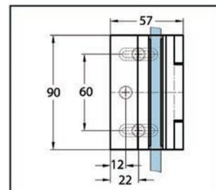
**i** Espesor 6, 8 mm · Agujero oblongo para montaje a pared · Sin necesidad de muescas en el vidrio · Solo se requieren taladros
