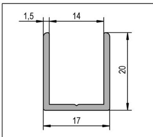
📌 Espesor 10 - 12,76 mm · Aplicaciones: ensamblaje de tabiques de vidrio permanentes, protección de bordes, marcos decorativos y varias aplicaciones · Esquinas redondeadas · Guía de broca en la parte inferior del perfil · Resistente a la corrosión y, por lo tanto, adecuada para su uso en el baño y la cocina.
