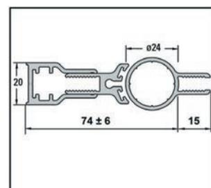
**i** Espesor 8 mm · Altura de elevación 5 mm · Posición de bloqueo en ambos lados en 90° · Longitud del perfil 2200 mm · Se puede acortar a la longitud deseada · Pida dos juegos para instalaciones de 2 puertas. · Perfiles complementarios están disponibles como accesorios para conectar con paneles laterales. · La medida de deducción de 13 mm ya está incluida en la muesca para insertar el deflector de agua BO 5213494. Si se utiliza otro deflector, hay que adaptar la muesca respectivamente.
