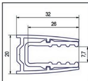
**i** Perfil conector a pared con función de abrazadera, adecuado para el sistema de puertas correderas Aquant 40 · Incl. inserto de plástico, no requiere pegado/sellado · Espesor 8 mm
