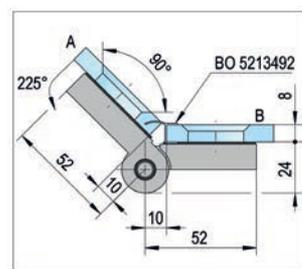
**i** Espesor 6, 8 mm · Altura de elevación 5 mm · Las puertas se mantienen cerradas mediante juntas magnéticas.
