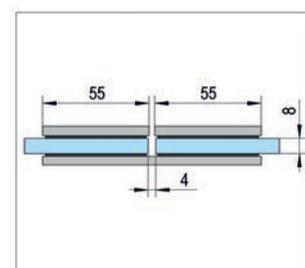
**i** Espesor 8, 10, 12 mm - Se entrega sin material de fijación. - Para tabiques fijos
