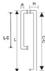
❗ Espesor vidrio templado 6 - 12 mm · Taladro en vidrio ø 12 mm · Distancia a los orificios centrales (C-C) 457/152 mm
