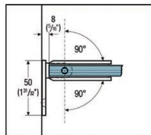
❗ Espesor 8, 10, 12 mm · Autocierre a partir de 15° · Se entrega sin material de fijación.
