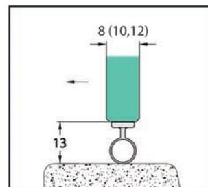
❶ Espesor 8 - 12 mm · Material PVC
