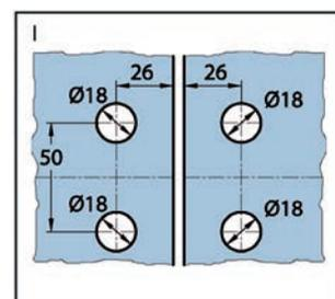
**i** Espesor 6, 8 mm · Sin necesidad de muescas en el vidrio · Solo se requieren taladros
