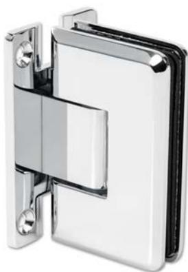
**i** Espesor 8, 10, 12 mm · Autocierre a partir de 15° · Posición zero de ajuste continuo · Se entrega sin material de fijación.
