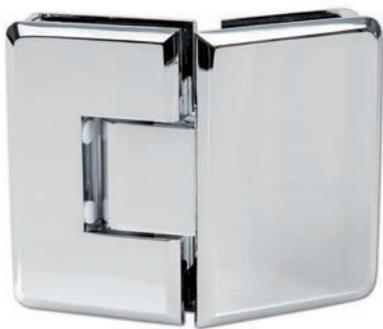
**i** Espesor 8, 10, 12 mm · Autocierre a partir de 15° · Posición zero de ajuste continuo · Se entrega sin material de fijación. · Para el montaje de una puerta batiente en un panel lateral
