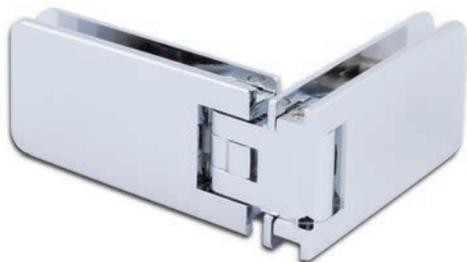
❶ Espesor 8, 10 mm · Autocierre a partir de 15° · Posición zero de ajuste continuo · Se entrega sin material de fijación. · Para el montaje de una puerta batiente en un panel lateral
