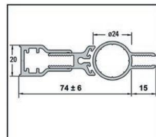
**i** Espesor 6 mm · Altura de elevación 5 mm · Posición de bloqueo en ambos lados en 90° · Longitud del perfil 2200 mm · Se puede acortar a la longitud deseada · Pida dos juegos para instalaciones de 2 puertas. · Perfiles complementarios están disponibles como accesorios para conectar con paneles laterales. · La medida de deducción de 13 mm ya está incluida en la muesca para insertar el deflector de agua BO 5213494. Si se utiliza otro deflector, hay que adaptar la muesca respectivamente.
