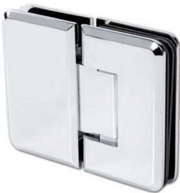
❶ Para el montaje de una puerta batiente en un panel lateral · Espesor 8, 10, 12 mm · Autocierre a partir de 15° · Se entrega sin material de fijación.
