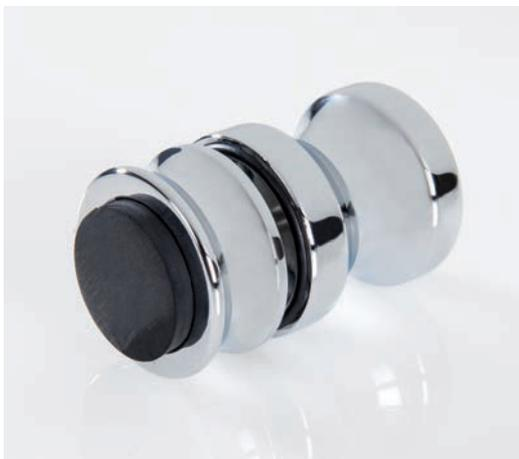
**i** Espesor vidrio templado 6, 8, 10, 12 mm · Taladro en vidrio  $\varnothing$  14 mm · amortiguador en un lado
