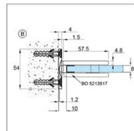
❗ Espesor 8, 10, 12 mm · Autocierre a partir de 15° · Posición zero de ajuste continuo · Se entrega sin material de fijación.
