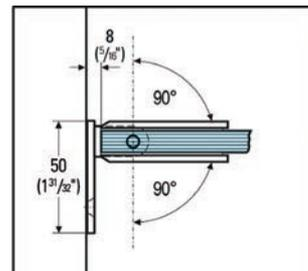
**i** Espesor 8, 10, 12 mm · Autocierre a partir de 15° · Posición zero de ajuste continuo · Se entrega sin material de fijación.
