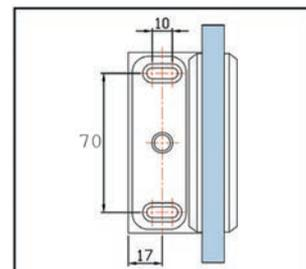
**i** Espesor 6, 8, 10 mm · Se entrega sin material de fijación.
