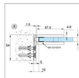
❗ Espesor 8, 10, 12 mm · Autocierre a partir de 15° · Posición zero de ajuste continuo · Se entrega sin material de fijación.
