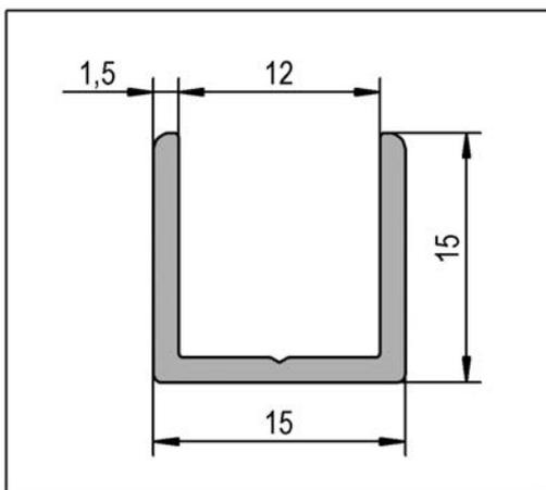
❶ Espesor 8 - 10 mm · Aplicaciones: ensamblaje de tabiques de vidrio permanentes, protección de bordes, marcos decorativos y varias aplicaciones · Esquinas redondeadas · Guía de broca en la parte inferior del perfil · Resistente a la corrosión y, por lo tanto, adecuada para su uso en el baño y la cocina.
