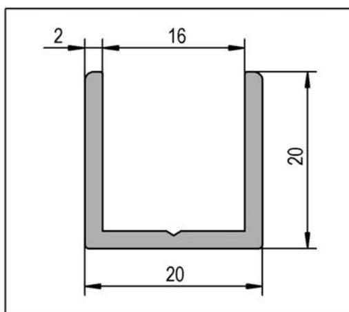
📌 Espesor 10 - 15 mm · Aplicaciones: ensamblaje de tabiques de vidrio permanentes, protección de bordes, marcos decorativos y varias aplicaciones · Esquinas redondeadas · Guía de broca en la parte inferior del perfil · Resistente a la corrosión y, por lo tanto, adecuada para su uso en el baño y la cocina.
