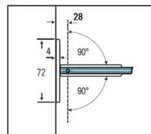
**i** Espesor 8, 10 mm · Posición cero ajustable  $\pm 5^\circ$  · Se entrega sin material de fijación.
