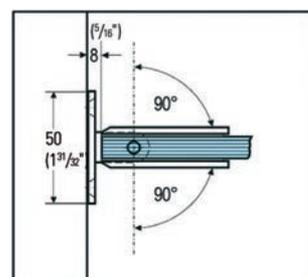
**i** Espesor 8, 10, 12 mm · Autocierre a partir de 15° · Posición zero de ajuste continuo · Se entrega sin material de fijación.
