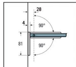
**i** Espesor 8, 10 mm · Posición cero ajustable  $\pm 5^\circ$  · Se entrega sin material de fijación.
