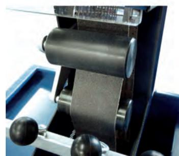
Belt position „lower edge grinding“
