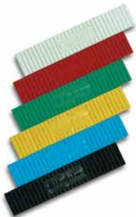
**i** Geprüftes, dichtstoffverträgliches Material · universell einsetzbar durch quengeriffelte Oberfläche und stabile Unterseite · die Form der Klötze garantiert eine bündige Anschlagverklotzung an der Glasfalzinnenkante · Hergestellt in Übereinstimmung mit den Technischen Richtlinien des Glaserhandwerks Nr. 3 "Klotzung von Verglasungseinheiten" · Tragfähigkeit pro Klotz max. 300 kg · Verpackungseinheit 100 Stück
