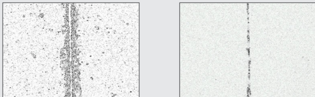
Abbildung: Trockenschnitt gegenüber Zuschnitt mit zugeführter Schneidflüssigkeit Silberschnitt® V55
