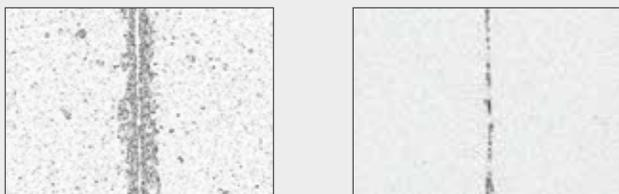
Figura: Taglio a secco rispetto ad uno realizzato con l'utilizzo di liquido da taglio Silberschnitt® V55
