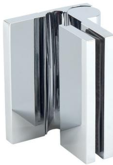
ⓘ Montage Glas-Wand 90° · max. Türgewicht pro Paar 40 kg · Glasdicke 6, 8, 10 mm · von unten einstellbare Nulllage · Rückholfunktion durch Hebe-Senk Mechanismus · verdeckte Schrauben · mit Hohlkehle · durchlaufende Dichtung · Hubhöhe 5 mm
