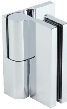
ⓘ Montage Glas-Wand 90° · max. Türgewicht pro Paar 40 kg · Glasdicke 6, 8, 10 mm · von unten einstellbare Nulllage · Rückholfunktion durch Hebe-Senk Mechanismus · verdeckte Schrauben · mit Hohlkehle · durchlaufende Dichtung · Hubhöhe 5 mm
