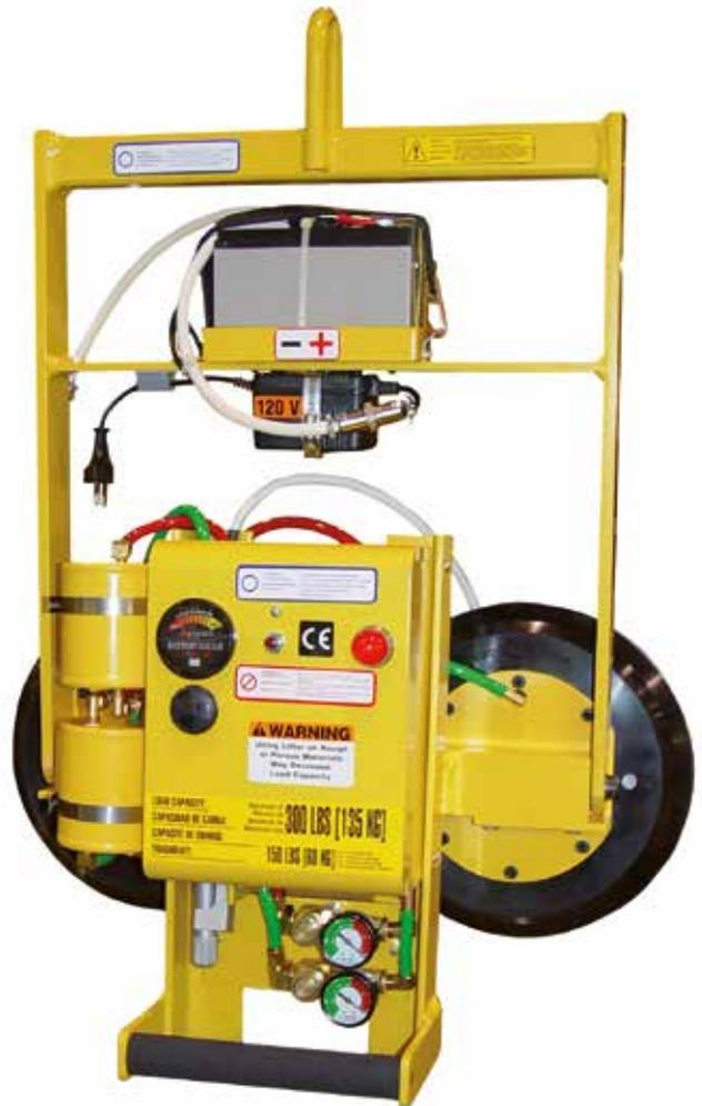
Dieses Vakuum-Hebegerät ist besonders leicht und platzsparend konzipiert. Durch seine geringen Abmessungen kann es auch in besonders schwierigen Anwendungssituationen benutzt werden. Dennoch ist eine Tragkraft von bis zu 135 kg möglich. Das Gerät verfügt über eine 90° Kippfunktion. Das batteriebetriebene Gerät ist mit einem 2-Kreis-Vakuumsystem ausgestattet und kann daher auch auf Baustellen benutzt werden.
