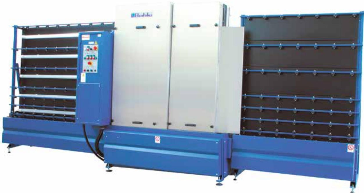
Die leistungsfähige Bohle Glaswaschmaschine Verti-Clean ist ideal für die Reinigung von Flachglas im Glaserhandwerk oder der Industrie. Das Glas wird über den automatischen Einlauf in die Waschzone befördert und dort mittels vier Bürsten zuverlässig gereinigt.
