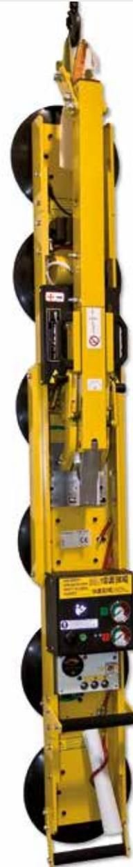
Dieses Vakuum-Hebegerät ist besonders leicht und platzsparend konzipiert. Durch seine geringen Abmessungen kann es auch in besonders schwierigen Anwendungssituationen benutzt werden. Dennoch ist eine Tragkraft von bis zu 500 kg möglich. Das Gerät ist um 180° drehbar und verfügt über eine 90° Kippfunktion. Das batteriebetriebene Gerät ist mit einem 2-Kreis-Vakuumsystem ausgestattet und kann daher auch auf Baustellen benutzt werden.
