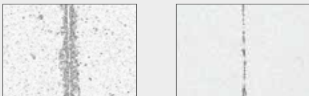
Ábra: A szárazon végzett vágás összehasonlítása Silberschnitt® V55 vágófolyadék alkalmazásával végzett vágással
